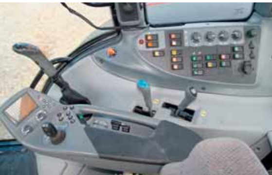
Bei der Ausstattung Advance (Option) ist die Multifunktionsarmlehne samt elektrischer Hydraulikventile Standard.
