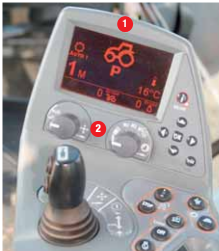
An die Programmierung der Steuergeräte über den Monitor (1) samt Vorwahl per Drehregler (2) muss man sich gewöhnen.
