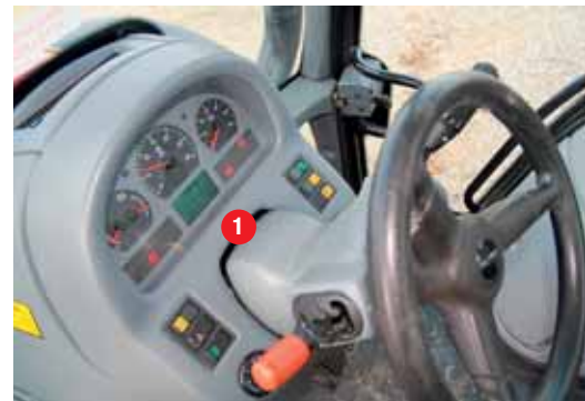
Vertrautes Cockpit, gute Verarbeitung. Im LCD-Display (1) stecken viele nützliche Anzeigen, wie eine Kraftstoffverbrauchsanzeige.
