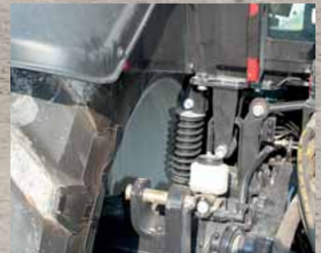
Die mechanische Federung der Kabine (1081 €) ist ok. Wer eine richtig gute Dämpfung will, wählt die semiaktive Federung.
