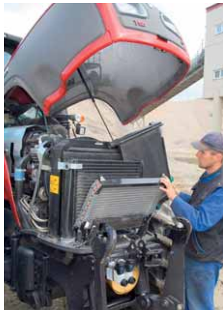
EcoPower: Der 6,6 l-Sisu-Sechszylinder läuft mit zwei Motor-Kennlinien.
