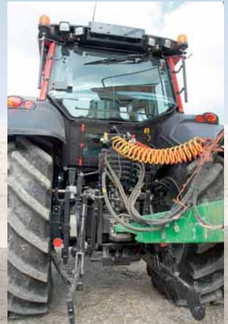
In der Advance-Ausstattung ist die 115 l/min-LS-Pumpe Serie. Für die Heckdreipunkt gibt Valtra 8100 daN Hubkraft an.
