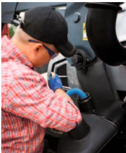
AdBlue zu tanken ist so einfach wie Diesel zu tanken oder Wischwasser aufzufüllen.
