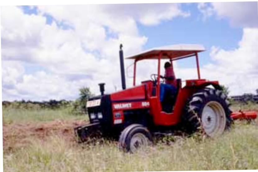
Der Valmet 604 wurde von einem 3,3 Liter 3-Zylindermotor mit 61 PS angetrieben. Bei dem ursprünglichen Getriebe handelte es sich um ein 6V+2R Getriebe. 1987 wurde es dann durch ein moderneres 8V+4R Getriebe und nassen Mehrscheibenbremsen ersetzt.
