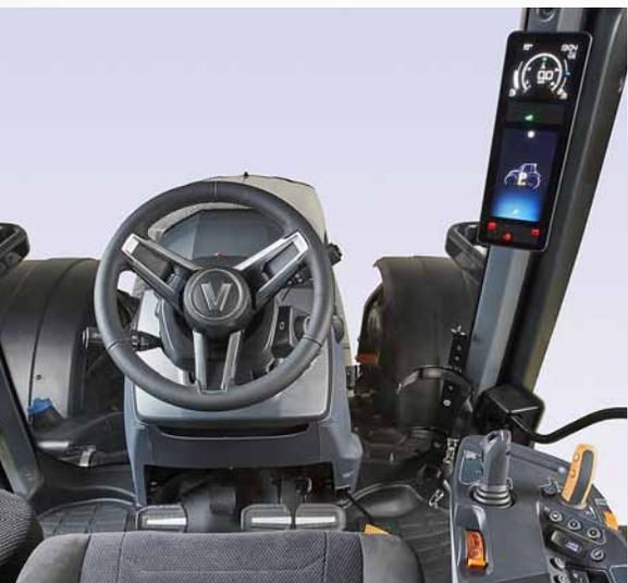
Die Kabine der neuen N- und T-Serie wurde gründlich überarbeitet. Das Kombiinstrument ist von der Lenksäule an die A-Säule gewandert, wo es gut sichtbar ist. Das etwa 15 x 40 cm große intelligente Display wird unterhalb des Lenkrads bedient.
