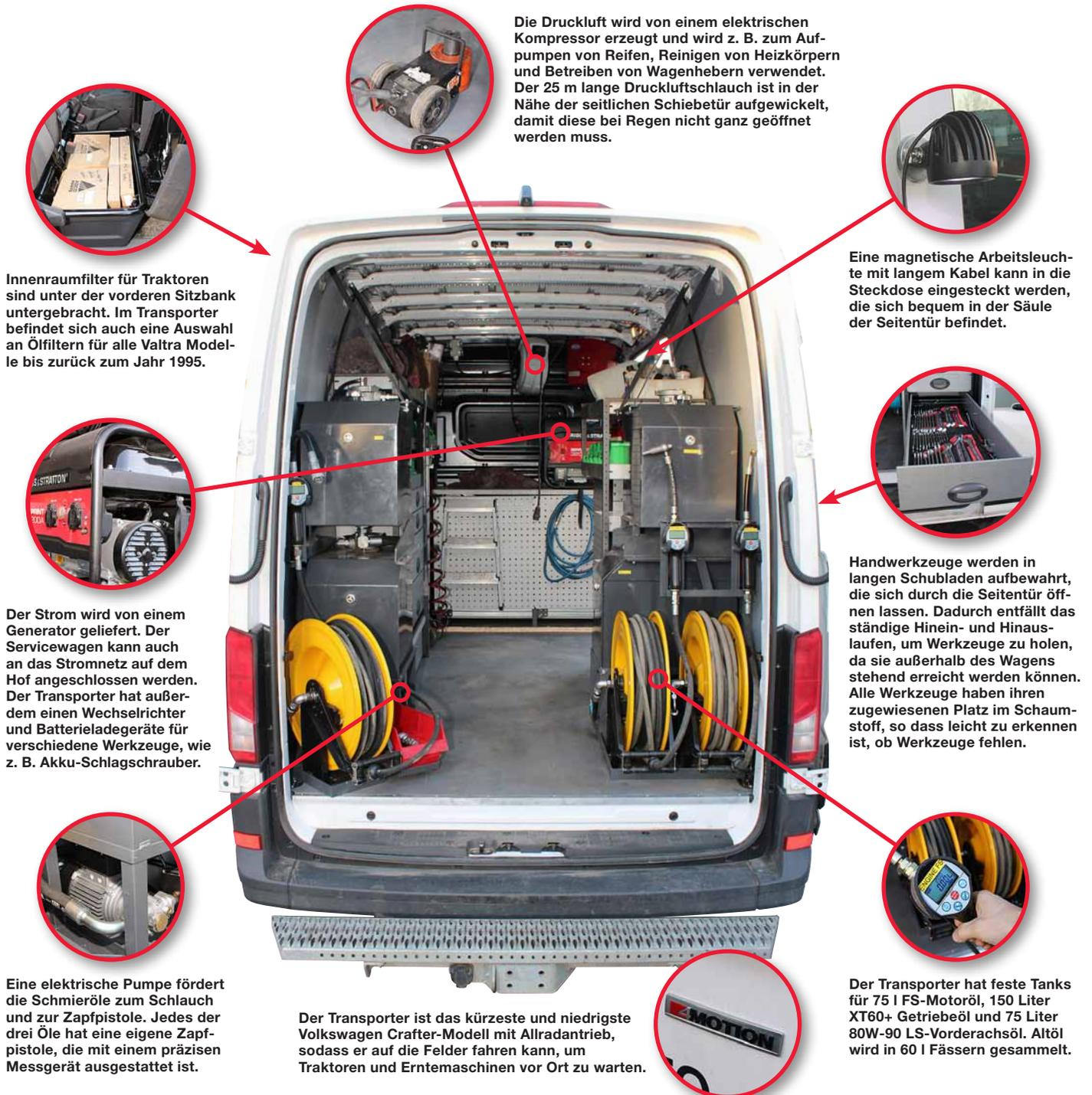
Die Druckluft wird von einem elektrischen Kompressor erzeugt und wird z. B. zum Aufpumpen von Reifen, Reinigen von Heizkörpern und Betreiben von Wagenhebern verwendet. Der 25 m lange Druckluftschlauch ist in der Nähe der seitlichen Schiebetür aufgewickelt, damit diese bei Regen nicht ganz geöffnet werden muss.
