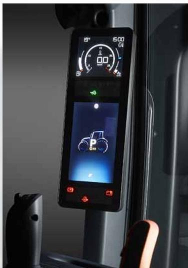
Bei den HiTech- und Active-Modellen erfolgen Motor-, Getriebe-, Hydraulik- und andere Einstellungen über das neue A-Säulen-Display. Bei allen Modellen dient dieses intelligente Display zur Anzeige der grundlegenden Instrumente und Warnleuchten sowie zur Anzeige individueller Informationen.
