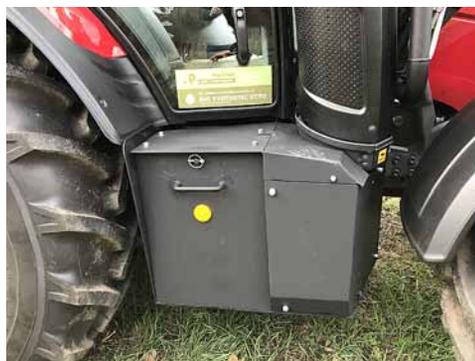
Stahlschutz auch für den Werkzeugkasten.
