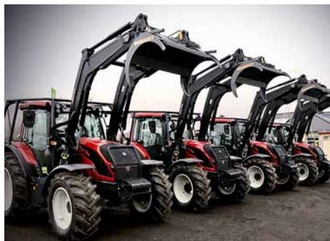
Valtra N104 Forstraktoren mit Frontlader und Polterschild bereit zur Auslieferung.
