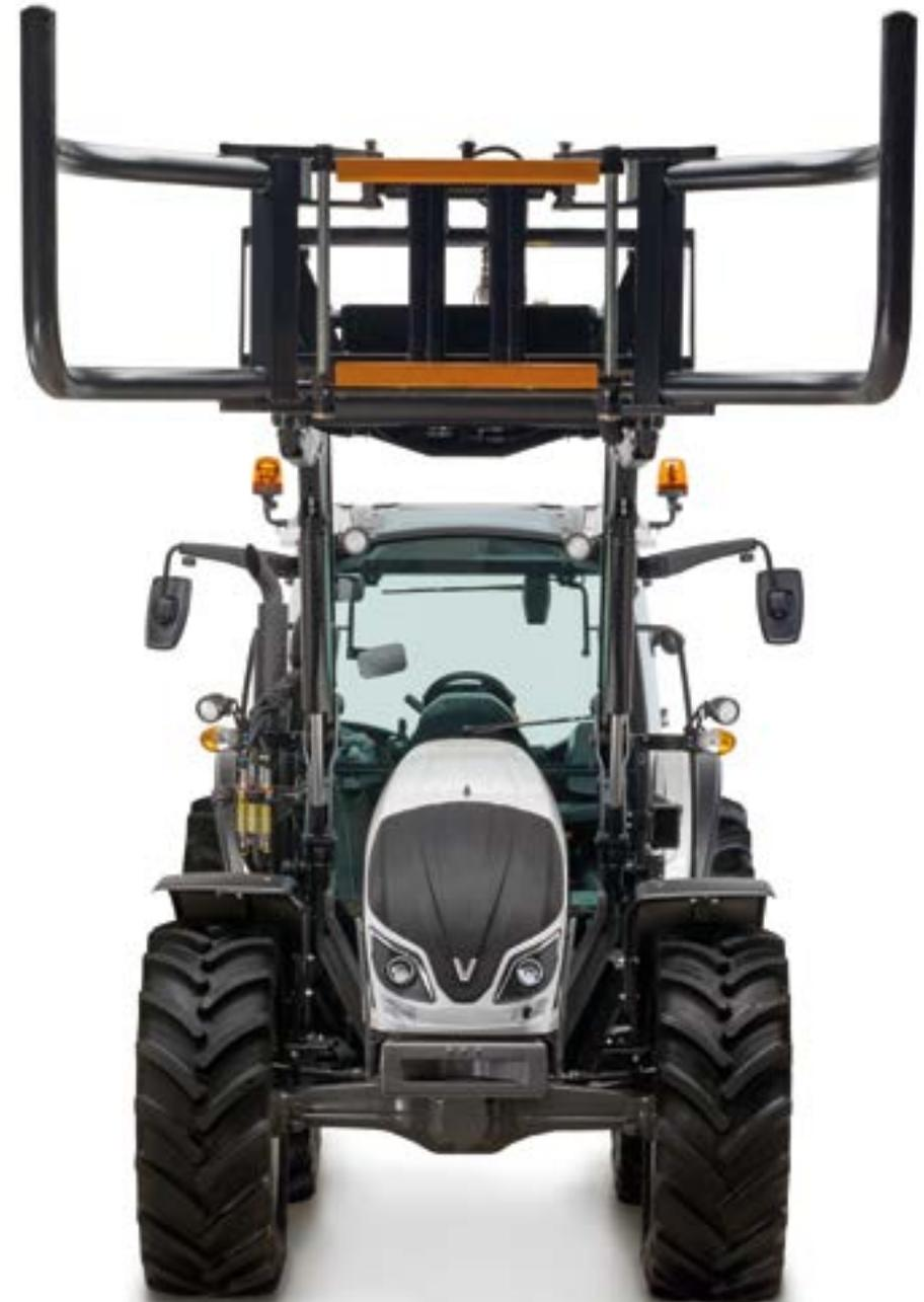
Valtra Frontlader sind in verschiedenen Größen und Leistungsklassen erhältlich, um Ihre speziellen Anforderungen zu erfüllen. Mit einer maximalen Hubhöhe von bis zu 4,75 m und einer maximalen Hubkapazität von bis zu 3.000 kg bleiben keine Wünsche offen.
