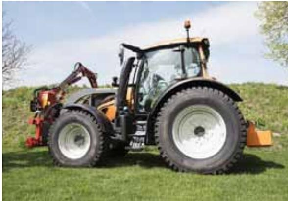
Der Kommunalrahmen wird an vorhandene Koppelpunkte des Traktors aufgebaut und kann somit ohne Einschränkungen auch für andere Einsätze demonstriert werden.
