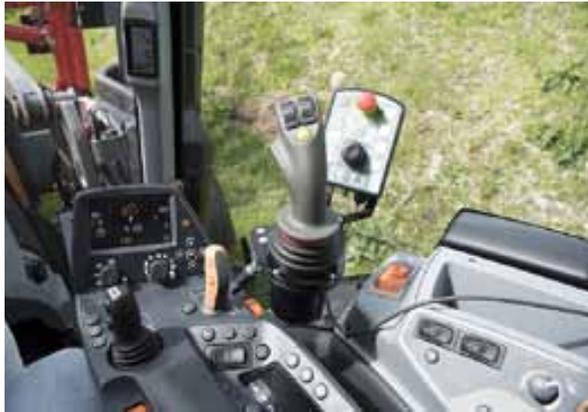
Dank der starken Schlepperhydraulik benötigt man keine zusätzliche Zapfwellen-Pumpe und das Gespann bleibt kompakt.
