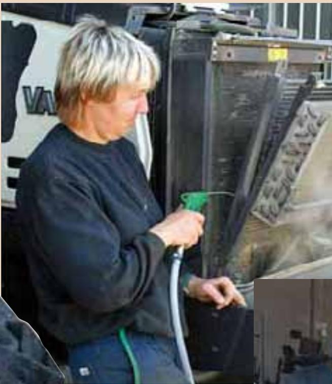
▲ Die Kühler müssen nach dem Einsatz in sehr staubiger Umgebung mit Druckluft gereinigt werden. Dabei ist die leichte Zugänglichkeit von Vorteil.
