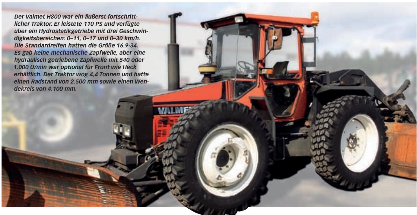
**Der Valmet H800 war ein äußerst fortschrittlicher Traktor. Er leistete 110 PS und verfügte über ein Hydrostatikgetriebe mit drei Geschwindigkeitsbereichen: 0–11, 0–17 und 0–30 km/h. Die Standardreifen hatten die Größe 16.9-34. Es gab keine mechanische Zapfwelle, aber eine hydraulisch getriebene Zapfwelle mit 540 oder 1.000 U/min war optional für Front wie Heck erhältlich. Der Traktor wog 4,4 Tonnen und hatte einen Radstand von 2.500 mm sowie einen Wendekreis von 4.100 mm.**
