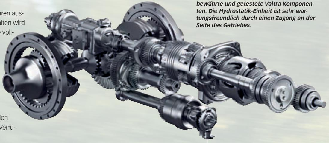
*Die neuen Getriebe wurden von Valtra selbst entwickelt und sind einzigartig. Das Wendegetriebe und die Hinterachse sind bereits bewährte und getestete Valtra Komponenten. Die Hydrostatik-Einheit ist sehr wartungsfreundlich durch einen Zugang an der Seite des Getriebes.*
