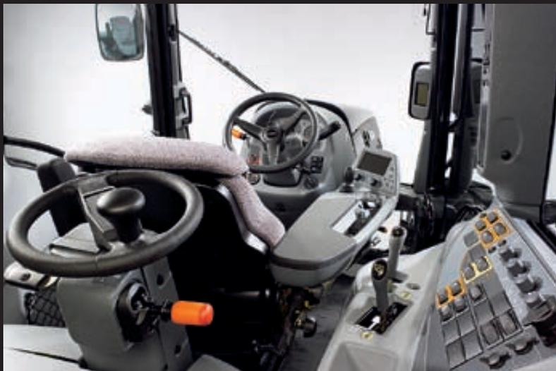
*Die Kabinen der Versu- und Direct-Modelle sind sehr geräumig, da keine Schalthebel mehr vorhanden sind. Die linke Seitenscheibe kann ausgestellt werden.*
