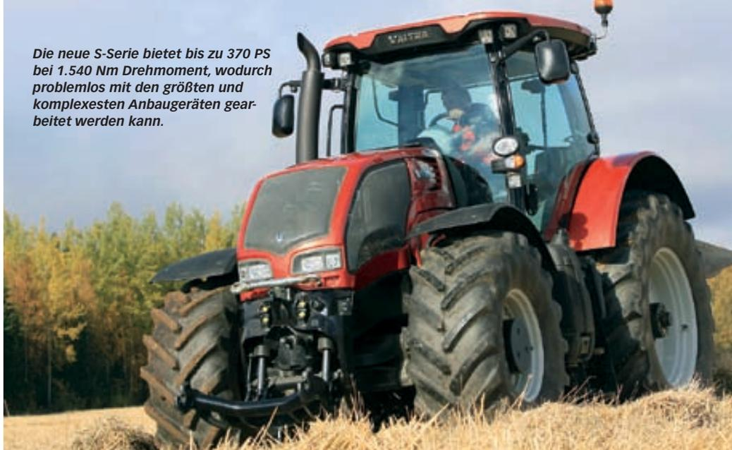
Die neue Traktorreihe wurde in enger Zusammenarbeit mit Valtras Mutterkonzern AGCO entwickelt. Herz und Rückgrat der S-Serie bilden der 84CTA-4V-Motor von AGCO Sisu Power (früher Sisu Diesel) und das stufenlose AVT-Getriebe (AGCO Variable Transmission).
