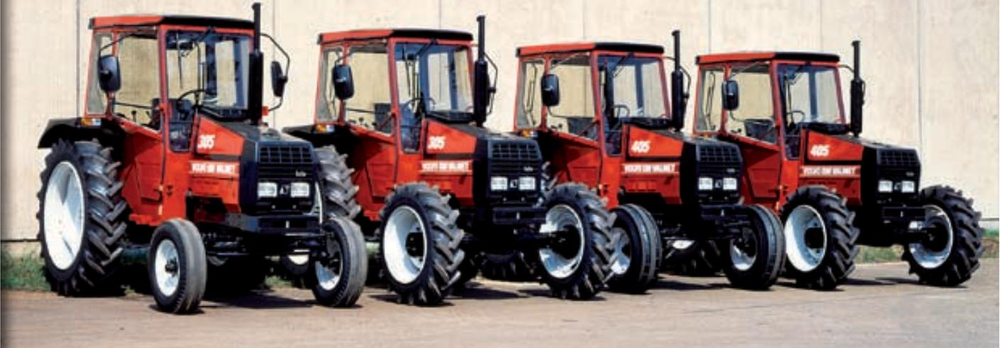
*Der Volvo BM Valmet 305-4/405-4 war ein erstklassiger Traktor mit vielseitigen Einsatzmöglichkeiten. Je nach Reifengröße brachte er 3.200 bis 3.300 kg auf die Waage. Das vollsynchronisierte Getriebe hatte 8 Vorwärts- und 4 Rückwärtsgänge bzw. 12V/8R mit optional erhältlichem Kriechgang.*
