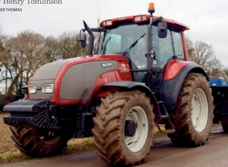
Landwirt und Lohnunternehmer Tomlinson ist mit seinem T150 HiTech höchst zufrieden. Das Drehmoment des Sisu-Motors und die zahlreichen Übersetzungen der dreistufigen Lastschaltung reichen völlig aus.
