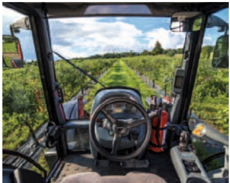
Dank den tief liegenden Kühlern ist die Sicht aus der Kabine überdurchschnittlich.
