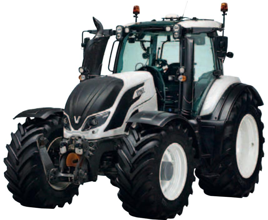
viert der Fahrer EcoPower, schaltet der Motorrechner auf eine 2. Kennlinie und die Drehzahl wird bei gleichzeitigem Drehmomentanstieg auf 1.800 Umdrehung gesenkt. Das reduziert den Kraftstoffverbrauch um ca. 10 %, verringert den Geräuschpegel und verlängert die Haltbarkeit des Motors.
