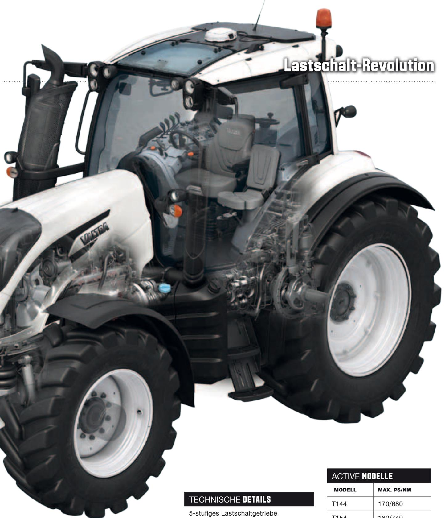
5 Lastschaltstufen und insgesamt 30 Gangabstufungen. Das Getriebe gibt es sowohl in einer 40- als auch in einer 50-km/h-Version und ist außerdem mit einem hilfreichen Berg-Anfahr-Assistenten ausgerüstet. •
