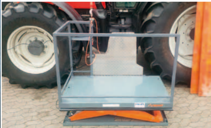
Einfach und effektiv: die umgebaute Motorradhebebühne.
