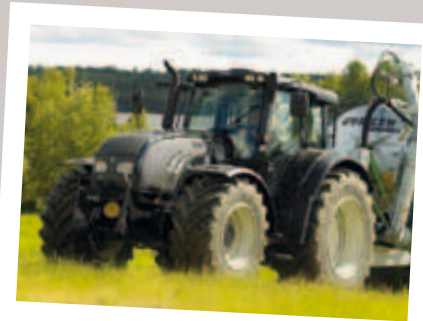
Der Valtra T202D war mit dem modernen Valtra-Stufenlosgetriebe Direct ausgerüstet, was eine Kombination von mechanischen und hydrostatischen Getriebeeinheiten ist.
