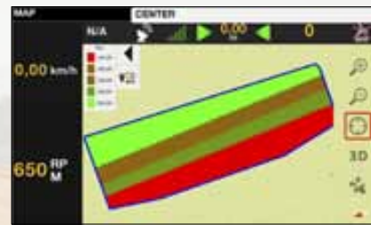
Variable Rate Control passt die Menge an Dünger oder Pflanzenschutzmittel variabel an die jeweiligen Bedürfnisse an.
