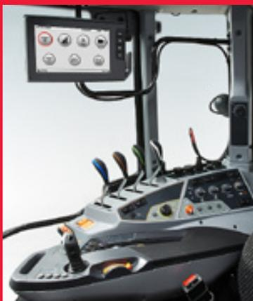
oben links: HiTech- und Active-Modelle der N- und T-Serie sind jetzt mit derselben Benutzeroberfläche wie die SmartTouch-Modelle erhältlich. Das Terminal ermöglicht die Verwendung von Smart Farming-Funktionen, z. B. der Spurführung Auto-Guide.
