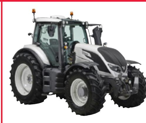
Die neuen Modelle der T- und N-Serie erkennen Sie an den schmalen Abgasrohren, die eine bessere Sicht von der Kabine aus ermöglichen.
