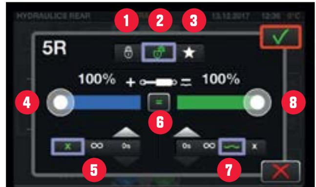
**TIPP:** Die Einstellungen für die Zusatzhydraulik sind unter einem Profil gespeichert. Wechseln Sie die Arbeit, so können Sie auch das Profil wechseln. So haben Sie immer alle Einstellungen passend parat und müssen die Zusatzhydraulik nicht immer wieder manuell neu belegen.
