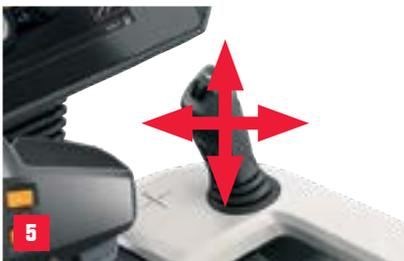
Die Verwendung des Hydraulik-Joysticks ist die einfachste Art, den Frontlader zu bedienen. Sie können den Frontlader aber auch über die proportionalen Taster auf dem Fahrhebel oder alle anderen Hydraulikhebel steuern.
