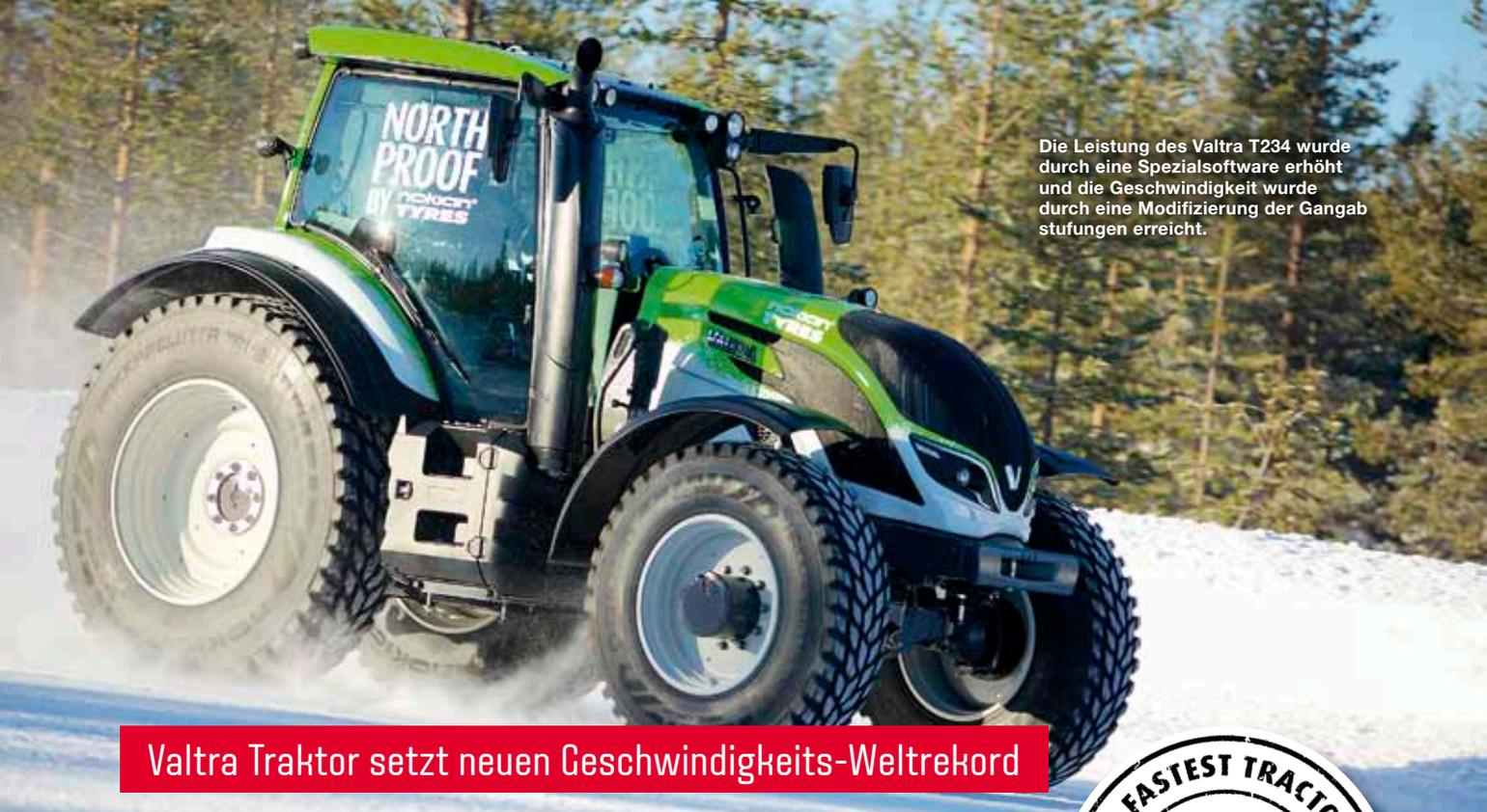
Die Leistung des Valtra T234 wurde durch eine Spezialsoftware erhöht und die Geschwindigkeit wurde durch eine Modifizierung der Gangabstufungen erreicht.
