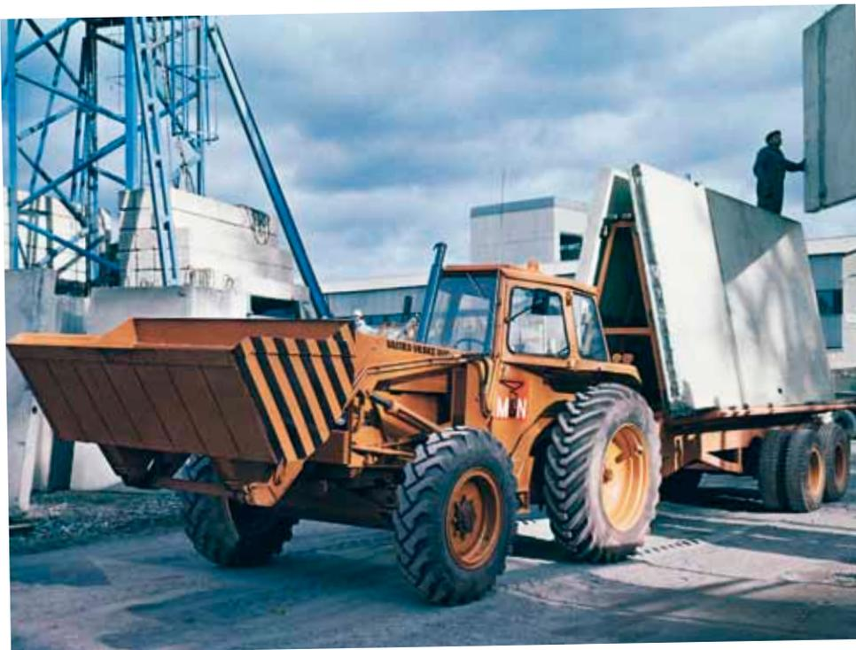
Der Valmet 1100-4 war im Jahr 1969 eine Maschine der Superlative: Allrad und 115 PS aus einem 4-Zylinder-Motor mit Turbolader.
