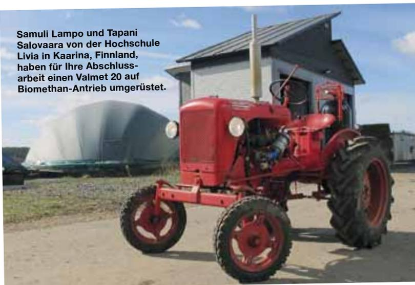
**“Am einfachsten kann man einen Valmet 15 von einem Valmet 20 an der Spurstange unterscheiden. Beim Valmet 15 befindet sich diese vor der Vorderachse, beim Valmet 20 dahinter.”**
