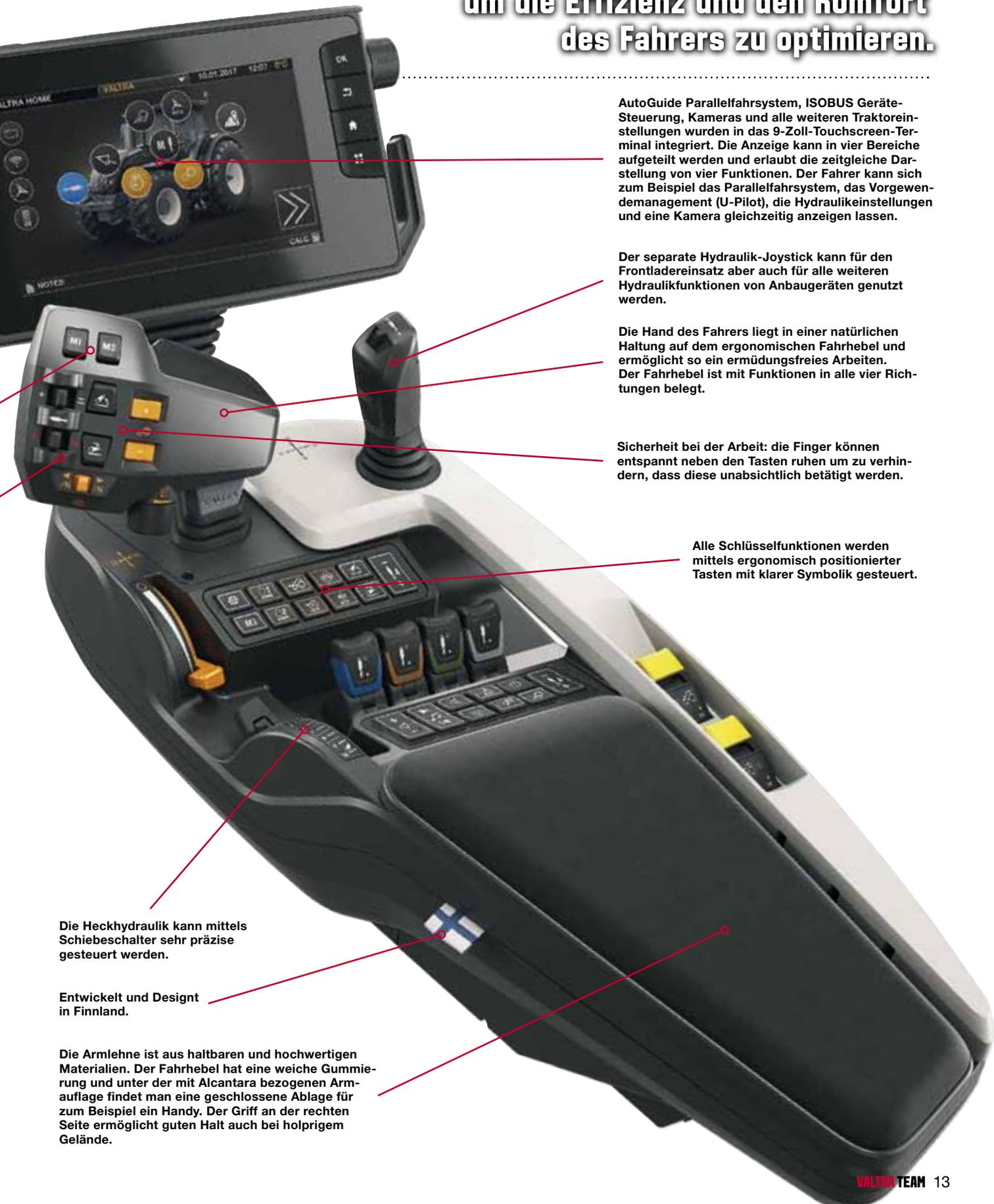
AutoGuide Parallelfahrssystem, ISOBUS Geräte-Steuerung, Kameras und alle weiteren Traktoreinstellungen wurden in das 9-Zoll-Touchscreen-Terminal integriert. Die Anzeige kann in vier Bereiche aufgeteilt werden und erlaubt die zeitgleiche Darstellung von vier Funktionen. Der Fahrer kann sich zum Beispiel das Parallelfahrssystem, das Vorgewendemanagement (U-Pilot), die Hydraulikeinstellungen und eine Kamera gleichzeitig anzeigen lassen.
