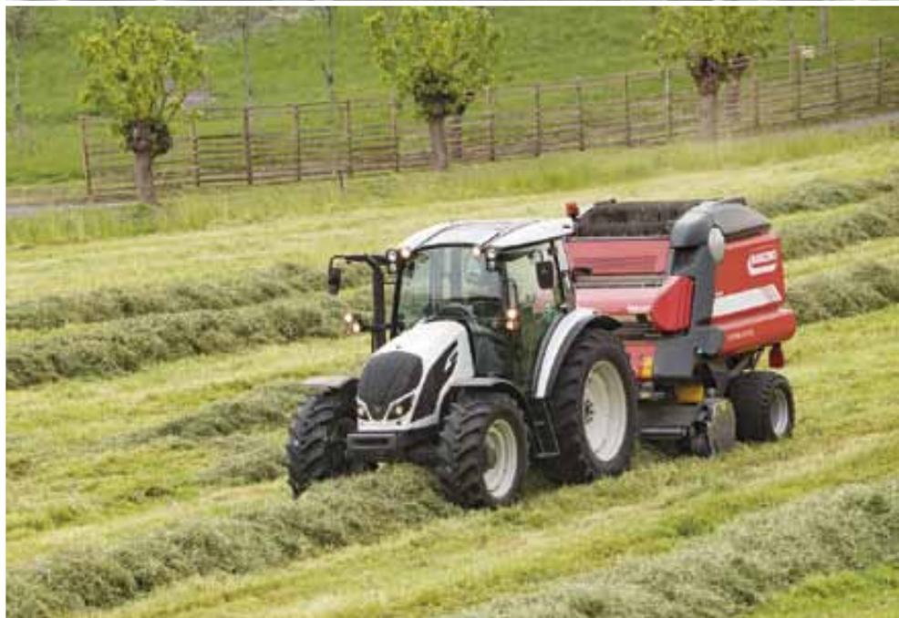
neues Kabinenkonzept mit einem der größten Platzangebote in dieser Traktorenklasse. Das neue Fahrerhaus ist komfortabel und ergonomisch, wodurch der Traktor angenehm und einfach zu bedienen ist. Die hervorragende Ergonomie wird durch die voll elektronische Steuerung von Allrad, Differentialsperre und Hubwerk unterstützt.
