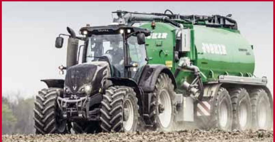
Der Valtra S394 ist mit beeindruckenden 405 PS und 1600 Nm Drehmoment jetzt das größte Modell der S-Serie. Die komplett überarbeitete Kabine ist mit der neuen Valtra SmartTouch Armlehne mit 9 Zoll Touchscreen ausgestattet, wie auch die Versu und Direct Modelle der N- und T-Serie.
