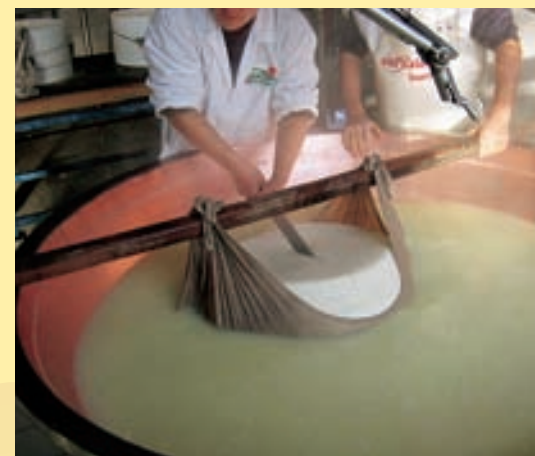
Die Milch wird in sehr großen, kegelförmigen Kupferkesseln geronnen, wobei nur Kälberlab verwendet wird.
