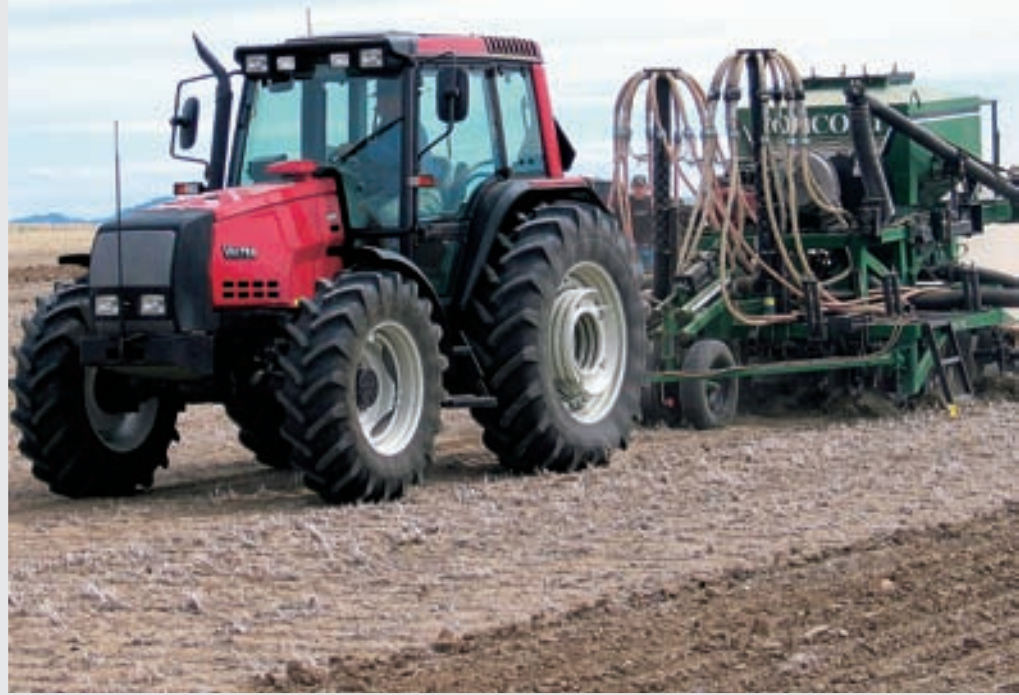
Der Valtra 6800 spielt eine Schlüsselrolle bei den NARC-Tests von Saatgut- und Düngerverteilersystemen mit Pressluft, wobei zwei verschiedenen Pressluftstärken getestet werden.
