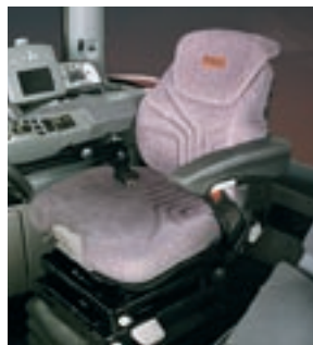
Damit Kinder den Traktor nicht starten können, ist eine Anlasperrung in den Fahrersitz eingebaut. Der Traktor lässt sich nur dann starten, wenn der Sitz mit dem Gewicht eines Erwachsenen belastet wird.
