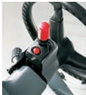
Die Feststellbremse ist in den Wählhebel integriert und wird mit der Hand bedient. Bei angezogener Feststellbremse kann das Fahrzeug nicht bewegt werden.
