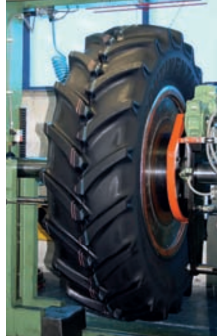
An einer weiteren Prüfstation misst eine Maschine den Rundlauf des Reifens.
