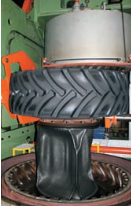
Aus dem Reifenrohling ist nach dem Heizprozess ein Landwirtschaftsreifen entstanden.
