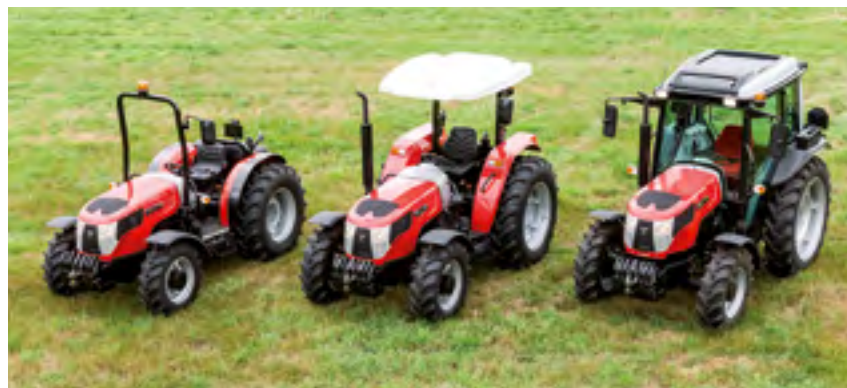
Die Traktoren der A-Serie sind mit unterschiedlichen Spurweiten und wahlweise mit Überrollbügel, variablen Sonnendach oder mit geschlossener Kabine erhältlich.
