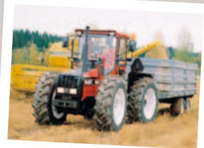
Der Valmet H800 fuhr mit einem rein hydrostatischem Getriebe und hatte auch für keine andere Funktion ein mechanisches Getriebe.
