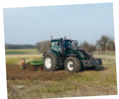
Das AutoGuide Spurführungssystem kann den Traktor mit einer Genauigkeit von wenigen Zentimetern steuern. Das 21-Meter-Gestänge der Amazone UX3200 Anhängespritze hat sieben Ventilbereiche. Das vom ISOBUS gesteuerte Section Control öffnet und schließt diese Bereiche je nach Bedarf, z.B. wenn der Traktor an einem ungeraden Feldrand über unbehandelte Fläche fährt.
