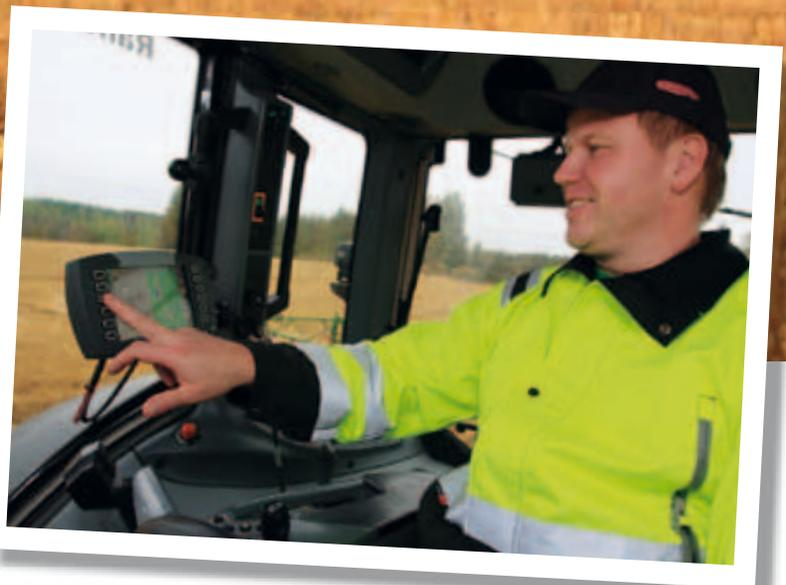
sein Spurführungssystem mit einem RTK-Kontrollsignal, was den Traktor bis auf wenige Zentimeter genau fahren lässt. Das ist in seinem Fall auch nötig, da die Satelliten so weit im Norden oft hinter Bäumen oder Hügeln sind. Das System erkennt außerdem die seitliche Neigung, wenn der Traktor und das Anbaugerät quer zu Hängen fährt und korrigiert entsprechend die Fahrbahn.
