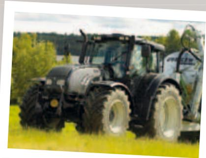
Der Valtra T202D war mit dem modernen Valtra-Stufenlosgetriebe Direct ausgerüstet, was eine Kombination von mechanischen und hydrostatischen Getriebeeinheiten ist.
