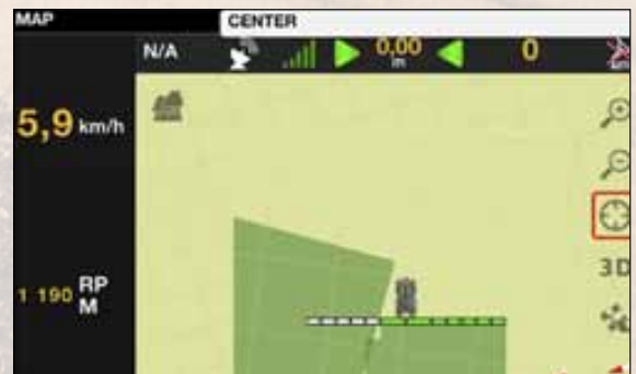
Section Control schaltet die einzelnen Sektionen unabhängig voneinander je nach Überlappung und hilft somit bei der Spritzung oder Düngung von nicht ideal geformten Flächen.
