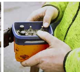
Winde und Traktor können über eine Fernsteuerung bedient werden.
