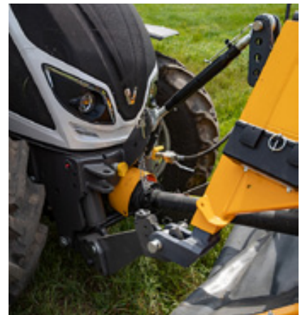
Die neue A-Serie kann im Unlimited Studio mit Frontkraftheber und Frontzapfwelle ausgestattet werden.
