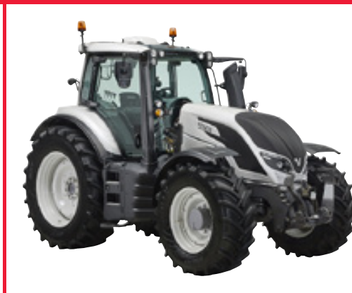
Die neuen Modelle der T- und N-Serie erkennen Sie an den schmaleren Abgasrohren, die eine bessere Sicht von der Kabine aus ermöglichen.
