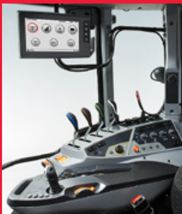
oben links: HiTech- und Active-Modelle der N- und T-Serie sind jetzt mit derselben Benutzeroberfläche wie die SmartTouch-Modelle erhältlich. Das Terminal ermöglicht die Verwendung von Smart Farming-Funktionen, z. B. der Spurführung Auto-Guide.
