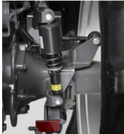
Die mechanische Kabinenfederung ist einstellbar und verwendet zwei Panhard-Stangen, um die Kabine zu stabilisieren.
