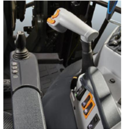
Dank des ergonomischen Hebels und der Wippschalter ist das Getriebe einfach zu bedienen.
