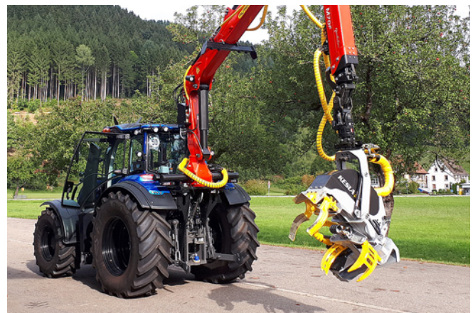
Valtra T234 mit Sicht auf Kesla Schubharvester und Krankonsole von Lorenz Müller.
