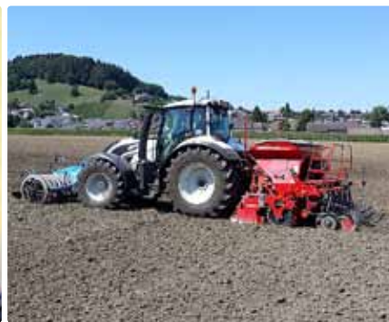
Säarbeiten mit Section Control und Variable Rate Control.
