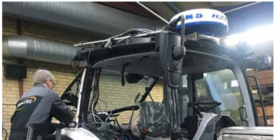
Die Valtra N154 ist ein Mehrzweckfahrzeug, das mit einer Vielzahl an Geräten ausgestattet werden kann, darunter ein Schiffsradar, eine Infrarot-Wärmesuchkamera und ein Suchscheinwerfer.
