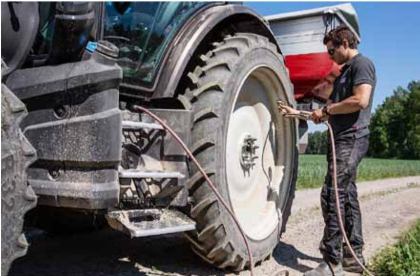
Die neue G-Serie ist mit einem seitlichen Druckluftanschluss beim Kabinenaufgang lieferbar, so dass z. B. der Reifendruck leicht eingestellt werden kann.
